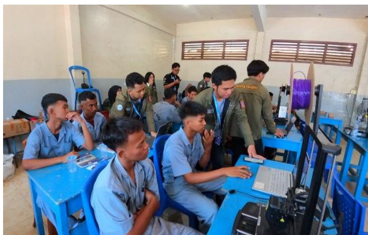
Gambar 5. Proses praktik pencetakan objek menggunakan mesin cetak 3D tipe FDM oleh peserta pelatihan.
